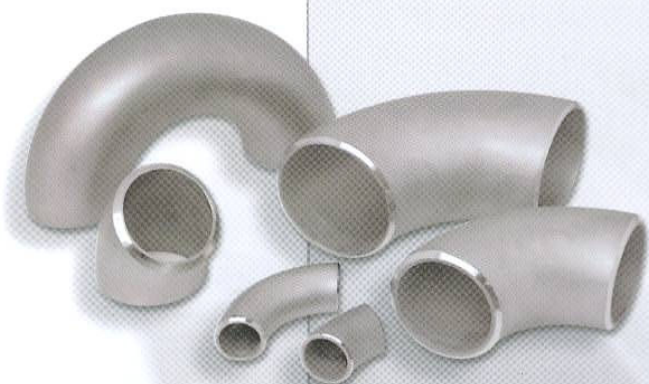
Curva Raio Longo 45°, 90° e 180° - 1/2" à 3" SCH 5S, SCH 10S e SCH 40S.
